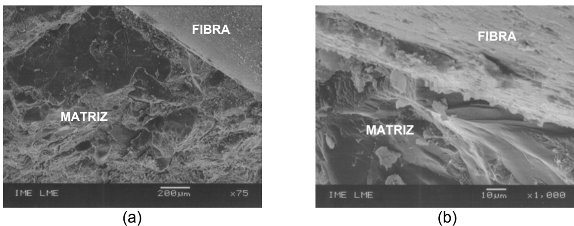
FIG. 5: Imagem de elétrons secundários da interface fibra/matriz obtidas por MEV. (a) CCG15 (75X). (b) CCG15 (1000X).
