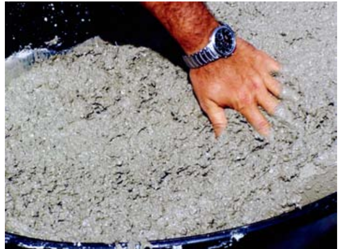
Trabalhabilidade da mistura do concreto reforçado com fibras
